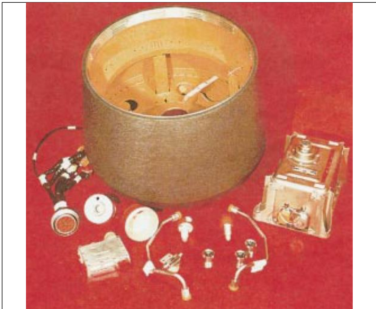
تصویری از بخش انتهایی یک سرجنگی چندگانه به همراه بلوک ایمنی و تسلیح (فیوز) الکترونیکی آن در سمت راست
